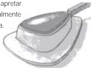
Para piedras sensibles al calor, crear un bisel para sujetar la piedra.
