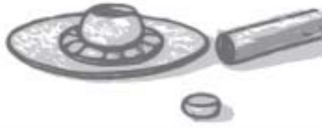
—Crear un apoyo para sostener una pequeña piedra facetada—
