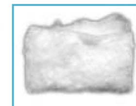
Proteger los objetos irregulares con trozos de manta de fibra de cerámica
